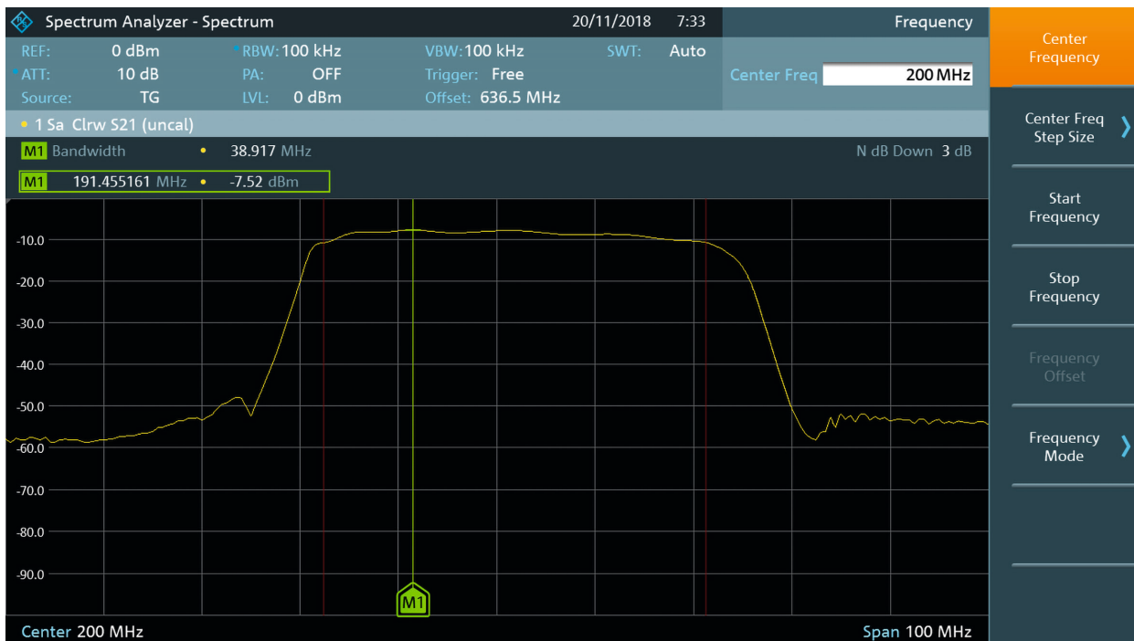
R&S®FPC1500: следящий генератор при измерении тракта сигнала со смесителями, фильтрами и усилителями
