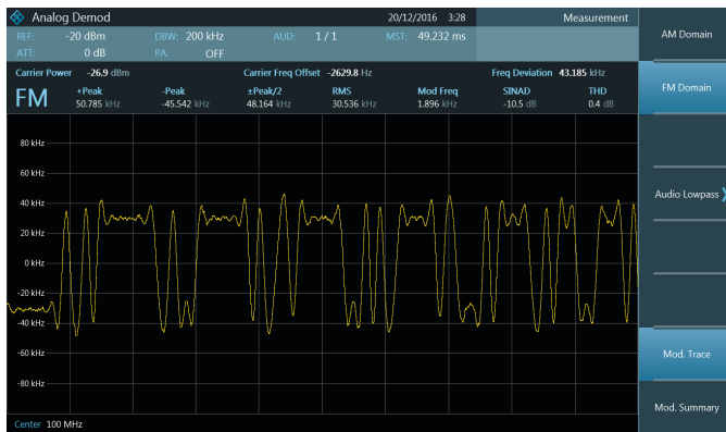
Опция R&S®FPC-K7: анализ ЧМ-модуляции
