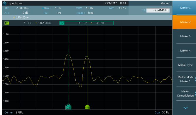
Опция R&S®FPC-B22: высокая чувствительность с внутренним предусилителем
